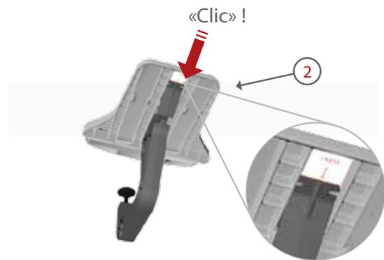
3. Tourner la vis de réglage dans un sens ou dans l'autre afin de l'ajuster à l'épaisseur de la table souhaitée.
